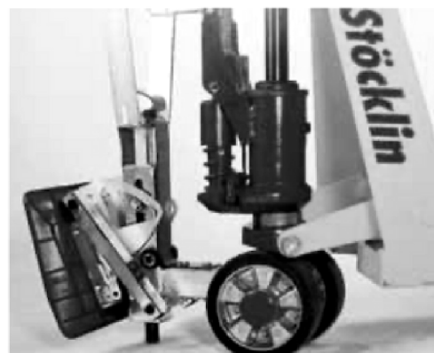
Drehbarer Mittelbolzen (Oberfläche gehärtet).
